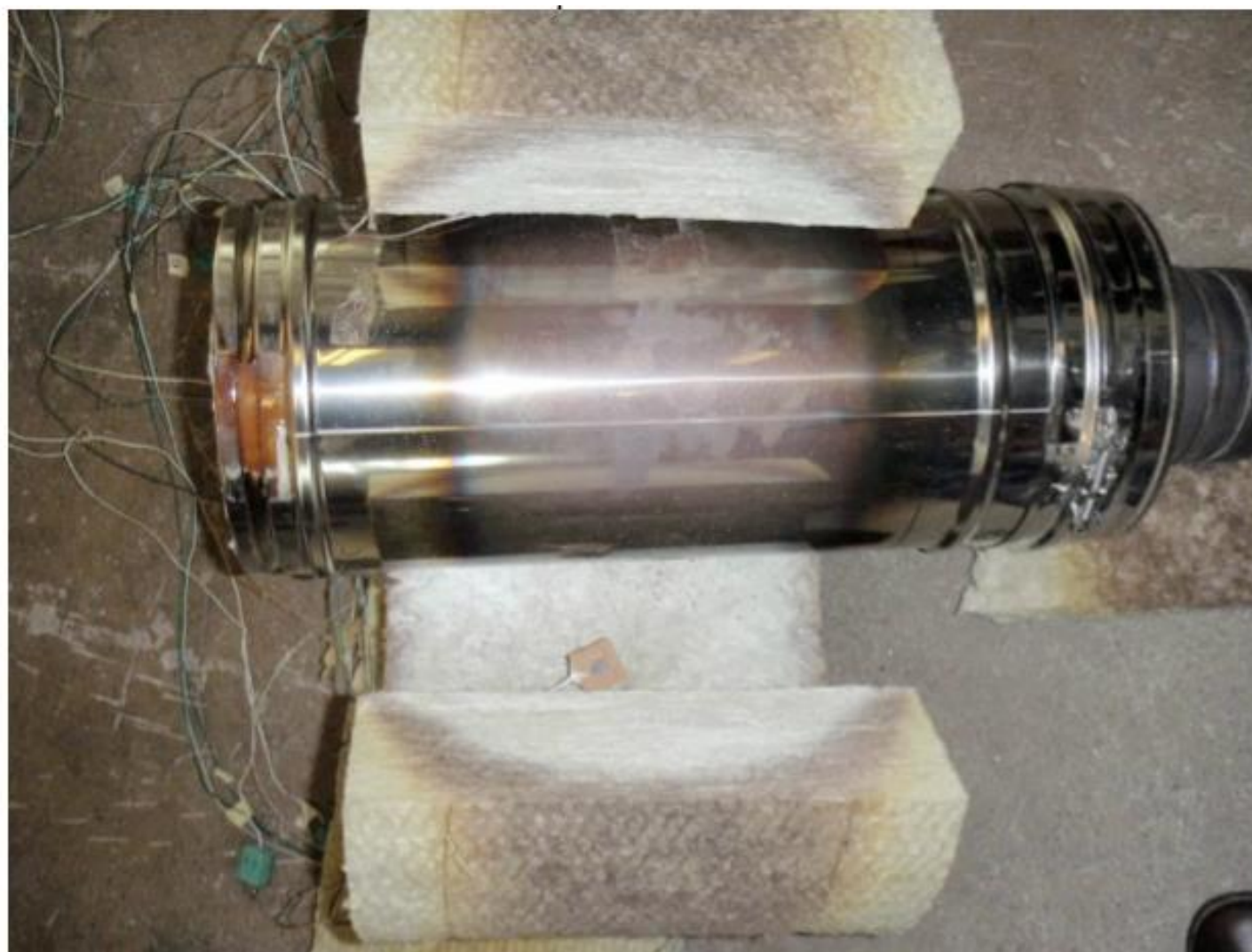
Kuva 11 Vauriot hormissa ja paloeristeessä seinäläpivientikokeen jälkeen.
