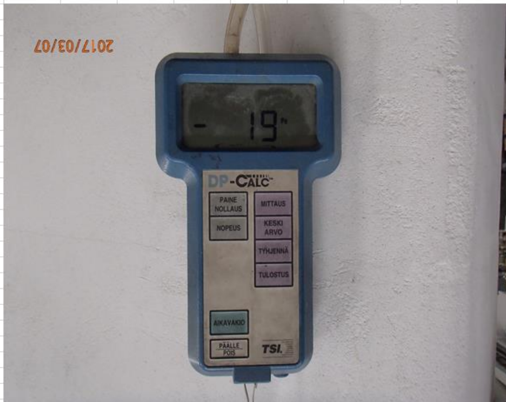
Kuva 5. Veto oli ensin 5 Pa luokkaa ja hetkessä hyppäsi 18-19 Pa:iin. Sytytyspelti aukaistu heti ensimmäisenä.
