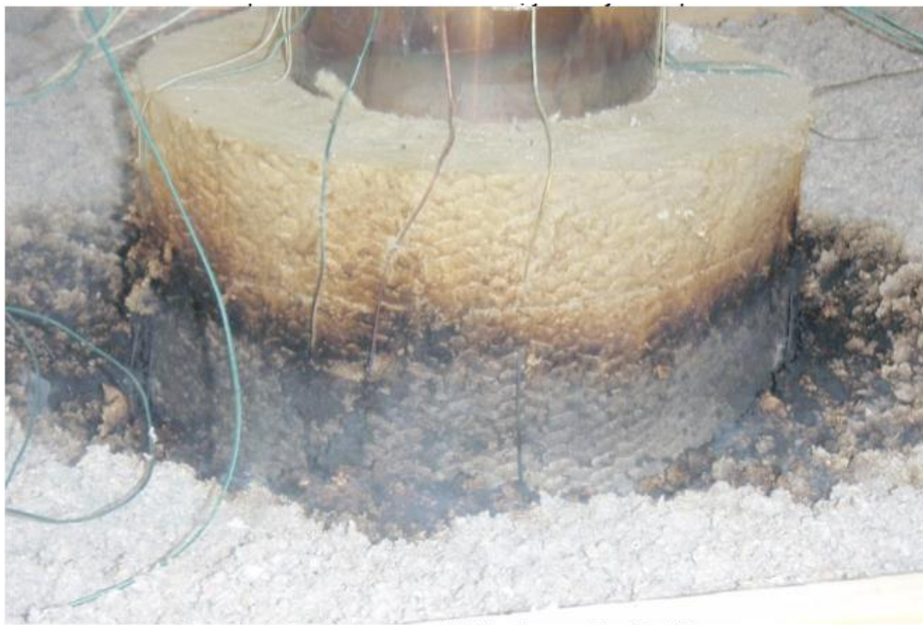
Kuva 4 Paloeristeen ympärillä oleva selluvilla hiiltyy.
